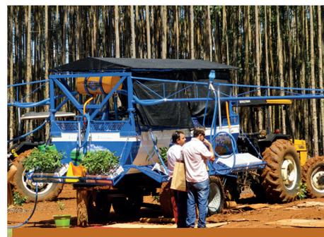
Tanque de irrigação adequado com válvulas para uniformizar a quantidade de água por planta
