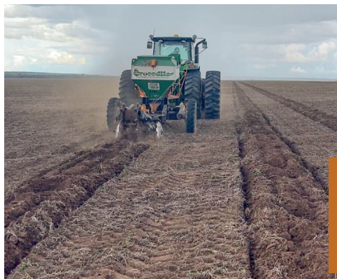
Preparo do solo com subsolador acoplado com disco de corte frontal, dosador de adubo, grade niveladora e marcador do berço de plantio
