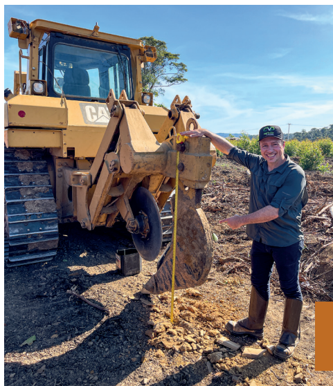
Ripper com subsolagem profunda em solos argilosos e compactados
